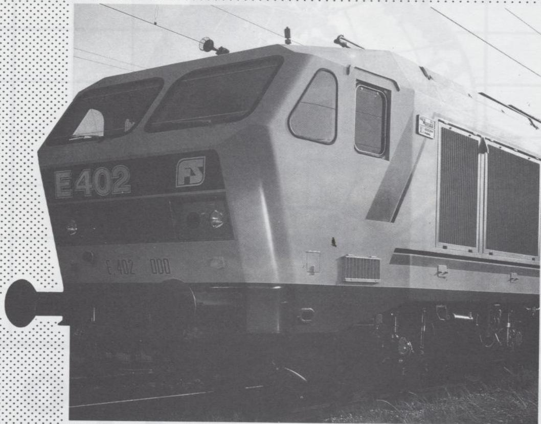
Sono molti i prodotti Ansaldo che vanno forte. Uno in particolare farà parlare di sé per la sua velocità: la locomotiva E 402. Le Ferrovie dello Stato hanno progettato la parte meccanica, l'Ansaldo Trasporti ha progettato e realizzato l'azionamento elettronico.
